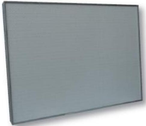
I filtri assoluti a pannello sono generalmente utilizzati in flussi unidirezionali con velocità di efflusso comprese tra 0,35 e 0,45 m/s. Sono caratterizzati da una perdita di carico iniziale contenuta e, se opportunamente pre-filtrati, da una lunga vita operativa. Sebbene la perdita di carico finale possa essere considerata di 500-600 Pa, per garantire un risparmio energetico significativo consigliamo di sostituire gli elementi al raggiungimento di 250-300 Pa.
