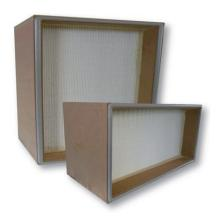
I filtri semiassoluti ed assoluti a pannello sono utilizzati sia in flussi unidirezionali (150mm) sia in flussi turbolenti (150-292mm). Sono caratterizzati da una perdita di carico iniziale contenuta; se opportunamente pre-filtrati garantiscono una lunga vita operativa. Sebbene la perdita di carico finale possa essere considerata di 500-600 Pa, per garantire un risparmio energetico significativo consigliamo di sostituire gli elementi al raggiungimento di 400-450 Pa.
