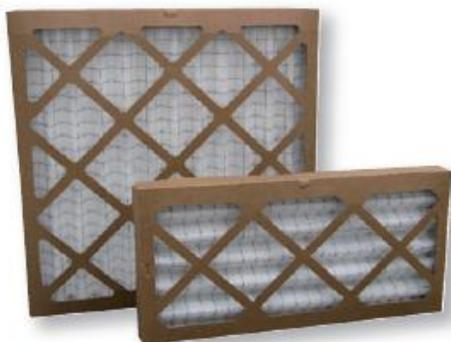
**I FILTRI TELAIO CARTONE sono caratterizzati da un'ampia superficie filtrante al fine di minimizzare le perdite di carico ed aumentare la capacità di accumulo. Sebbene la perdita di carico finale sia di 250 Pa si consiglia la sostituzione degli elementi tra 150 e 200 Pa. Una corretta gestione dei sistemi filtranti garantisce, infatti, un sensibile risparmio energetico.**
